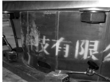
图5 隔震支座破坏形态 (试件LNR2)
