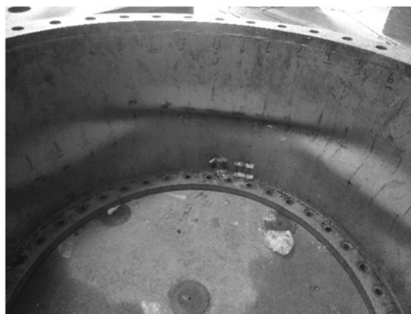
(b) 实验模型钢筒屈曲失稳
