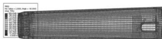
(a) 破坏极限钢筋塑性应变分布
