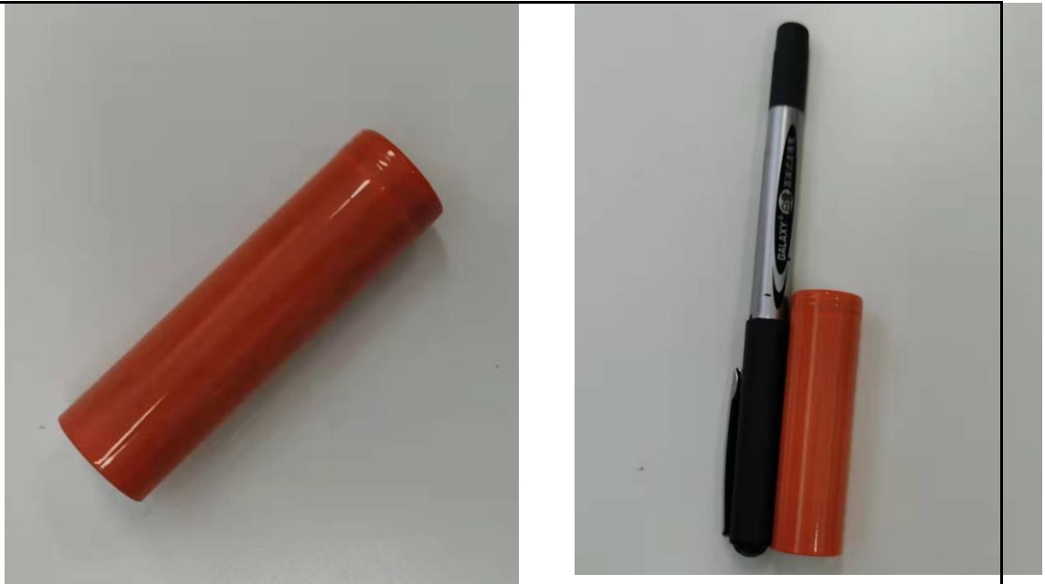
图 2-3 圆柱电池（直径 18mm;长度 65mm）
